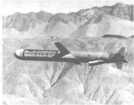
图 1-4 采用涡轮风扇发动机的“战斧”巡航导弹
