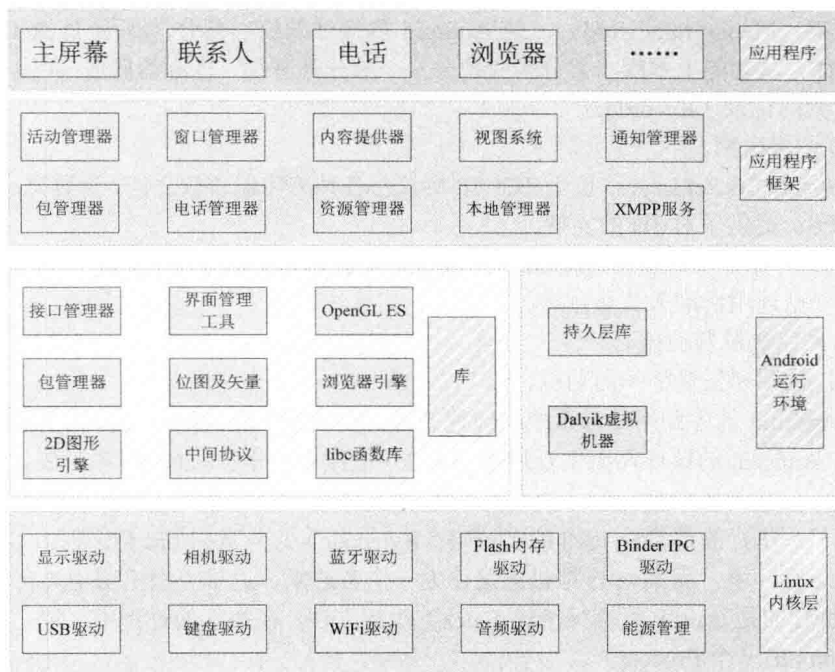
图 1-2 Android 操作系统的组件结构图
