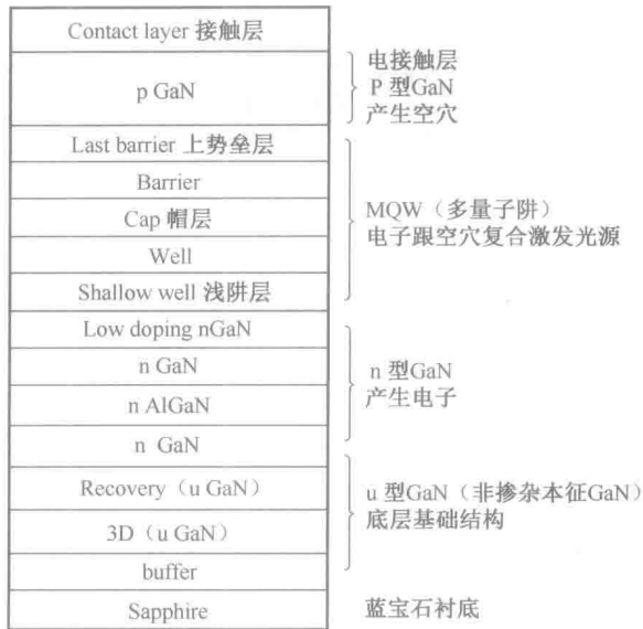
图 1-1 LED 多层结构示意图
