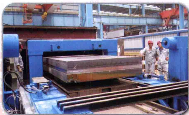
真空制坯复合轧制装备与技术生产特厚钢板，填补了国内利用连铸坯生产特厚板工艺空白，荣获冶金行业科技进步二等奖
