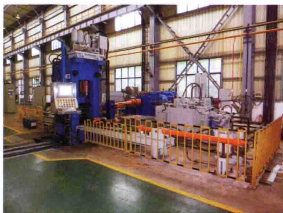
450mm 高精度液压张力冷 - 温轧实验轧机
