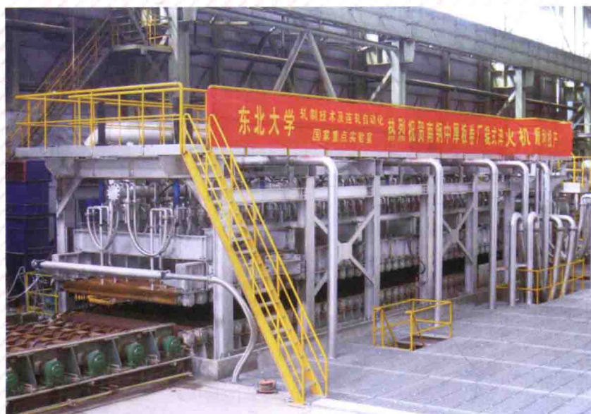
东北大学多功能宽厚钢板辊式淬火成套技术装备实现薄规格钢板高平直度淬火等多项技术突破，荣获 2014 年国家科技进步二等奖
