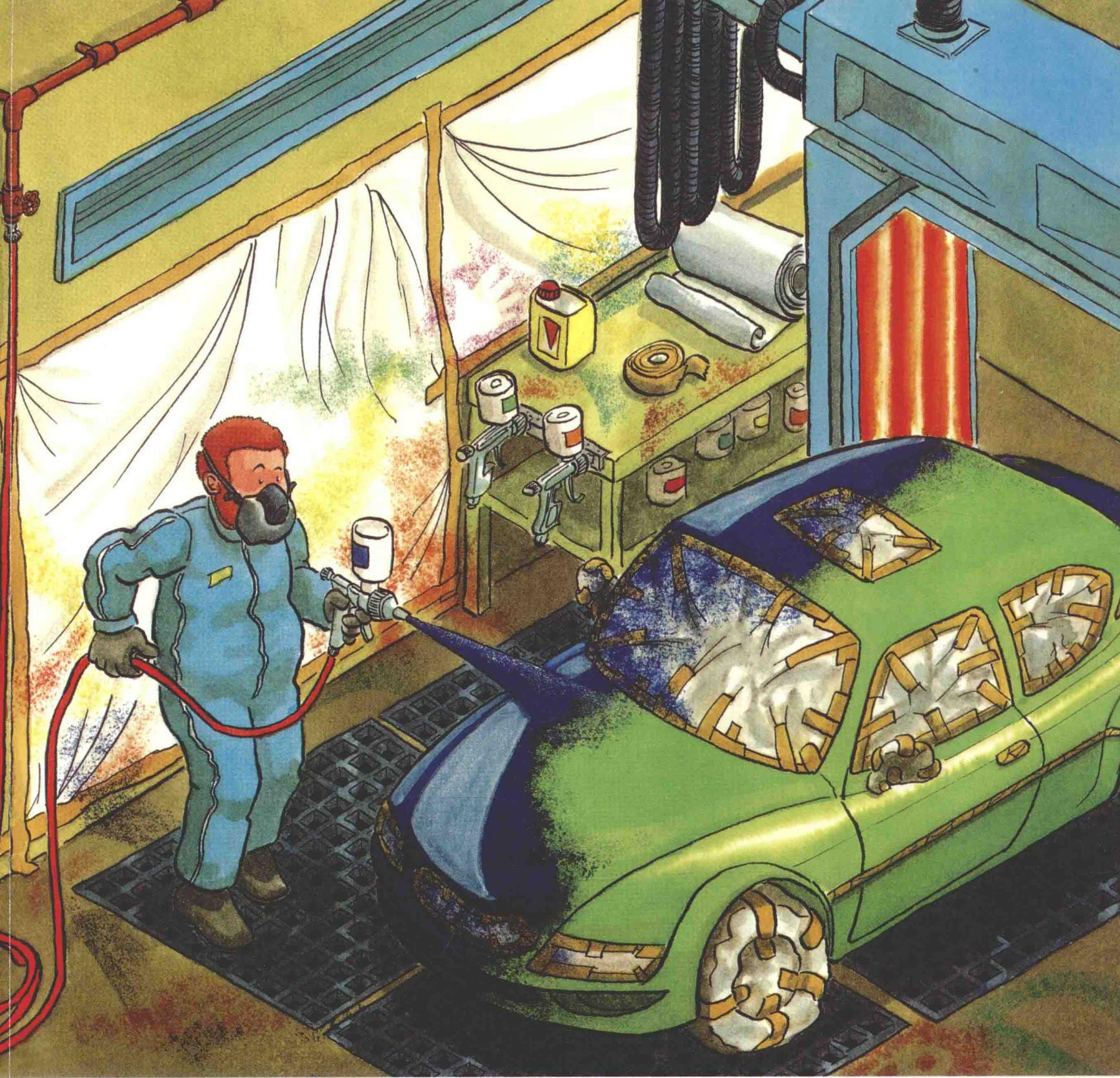
有一辆车正在喷漆室里重新上色，不喷漆的部分需要用纸和胶带封好。接着，工人会用喷枪喷出带颜色的雾给汽车上色。上色后，汽车看上去就跟新的一样了。
