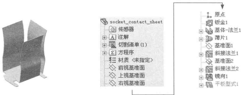
图 1.1 钣金件模型及设计树
