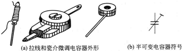
图 1-6 微调电容器外形及符号
