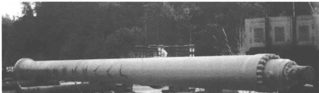
图 1-2 快速闸门用 8000kN/6000kN 超大型液压启闭机
