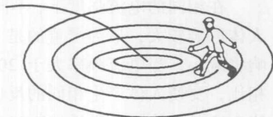
图 2.1.3 跨步电压触电
