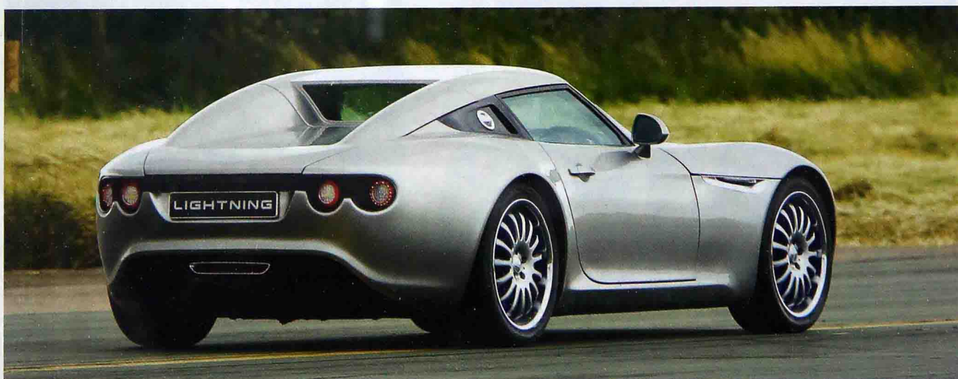
闪电GT (LIGHTNING GT) 4台120千瓦轮边电动机把采用凯夫拉尔增强合成材料车身的双座车型变成有超级跑车性能的电动汽车。制造商讲，这款车时速从0跃升到100千米只需要4秒
