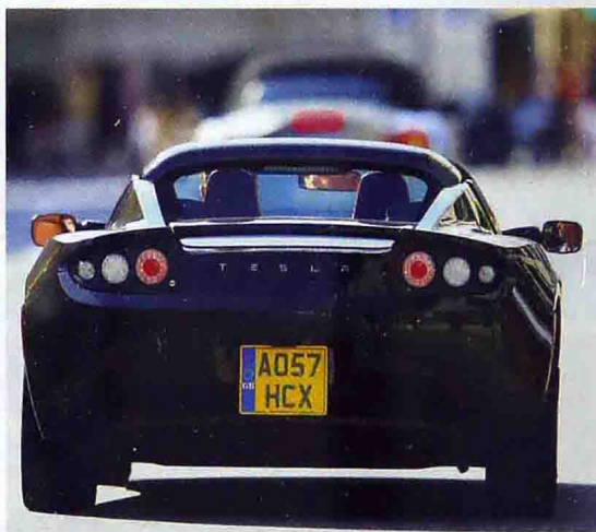
特斯拉双座敞篷跑车 (TESLA ROADSTER) 这款由纯电力驱动的跑车以改进的莲花爱丽丝底盘为基础，使用锂离子蓄电池（绿色），续航里程可达400千米
