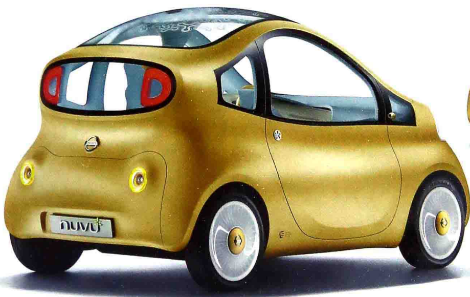
日产新视野 (NISSAN NUVU) 如果一个来自迪斯尼世界的人物从这款2+1座小型车中下来, 那肯定是种幻觉。新视野不想只成为小巧玲珑的滑稽汽车。实际上, 它将从2011年起参加法国的电动汽车大规模试验, 并在一年后投入批量生产。功率66千瓦和续航里程120千米, 完全是实验数据
