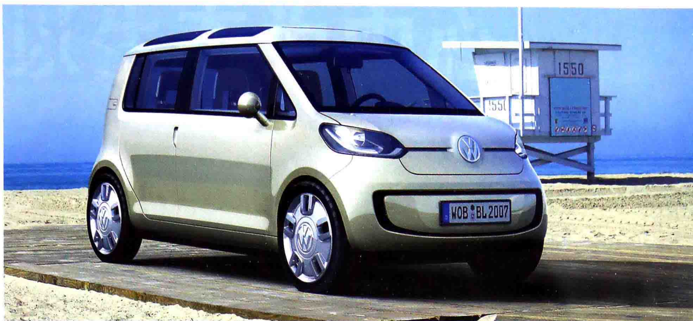
大众汽车SPACE UP BLUE (VOLKSWAGEN SPACE UP BLUE) 这款微型厢式车的外观很像从前的大众汽车桑巴 (Samba) 客车, 不过, 它采用的是45千瓦的电动机。锂离子蓄电池、车顶上的太阳能蓄电池和燃料电池可延长续航里程, 这些都着眼于未来。与客车一样, 驱动电机安装在车尾
