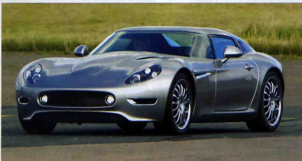
闪电GT (LIGHTNING GT) 4台120千瓦轮边电动机把采用凯夫拉尔增强合成材料车身的双座车型变成有超级跑车性能的电动汽车。制造商讲，这款车时速从0跃升到100千米只需要4秒
