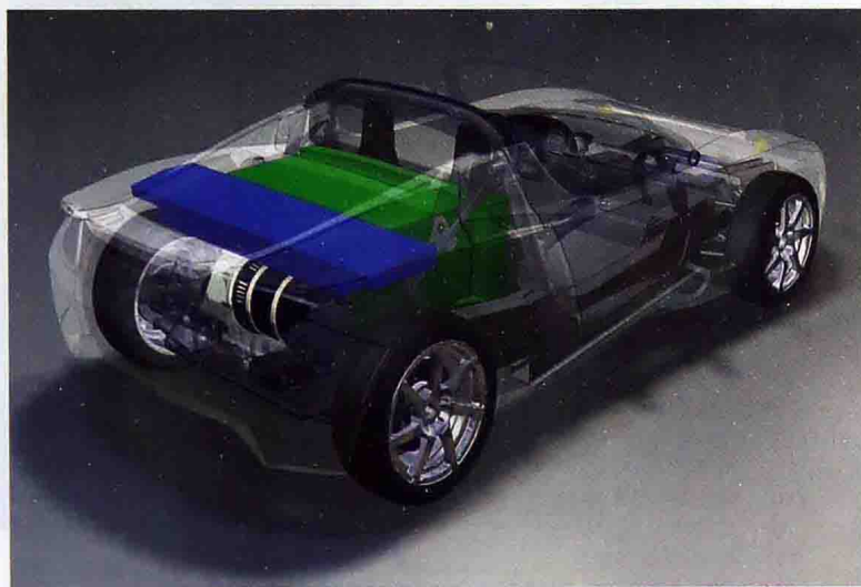
特斯拉双座敞篷跑车 (TESLA ROADSTER) 这款由纯电力驱动的跑车以改进的莲花爱丽丝底盘为基础，使用锂离子蓄电池（绿色），续航里程可达400千米
