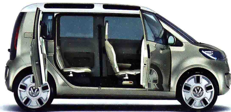
大众汽车SPACE UP BLUE (VOLKSWAGEN SPACE UP BLUE) 这款微型厢式车的外观很像从前的大众汽车桑巴 (Samba) 客车, 不过, 它采用的是45千瓦的电动机。锂离子蓄电池、车顶上的太阳能蓄电池和燃料电池可延长续航里程, 这些都着眼于未来。与客车一样, 驱动电机安装在车尾
