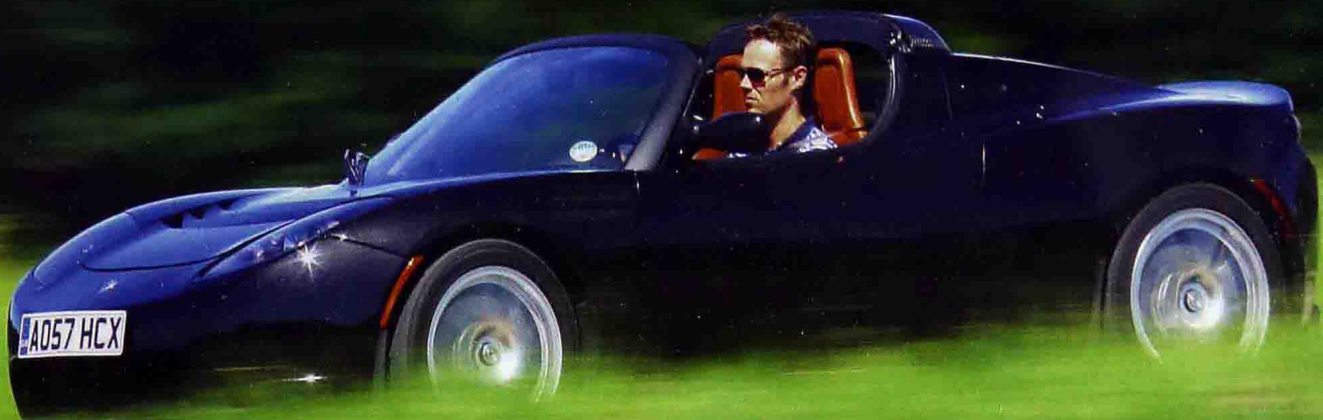
特斯拉双座敞篷跑车 (TESLA ROADSTER) 这款由纯电力驱动的跑车以改进的莲花爱丽丝底盘为基础，使用锂离子蓄电池（绿色），续航里程可达400千米
