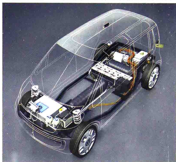
大众汽车SPACE UP BLUE (VOLKSWAGEN SPACE UP BLUE) 这款微型厢式车的外观很像从前的大众汽车桑巴 (Samba) 客车, 不过, 它采用的是45千瓦的电动机。锂离子蓄电池、车顶上的太阳能蓄电池和燃料电池可延长续航里程, 这些都着眼于未来。与客车一样, 驱动电机安装在车尾
