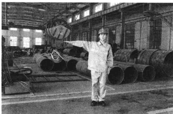
图 1-2-7 吊钩水平移动 2
