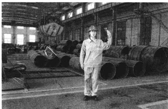
图 1-2-8 吊钩水平移动 3
