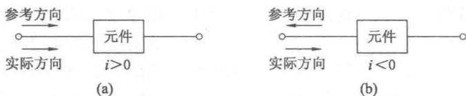
图 1.1.2 电流的参考方向与实际方向的关系
