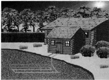
图 1-1 水平式地理管换热器系统
