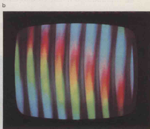
彩色板19. 吹風機效應，呈現在 (a)NTSC彩色條圖型；(b)彩虹信號產生器之彩色條圖型
