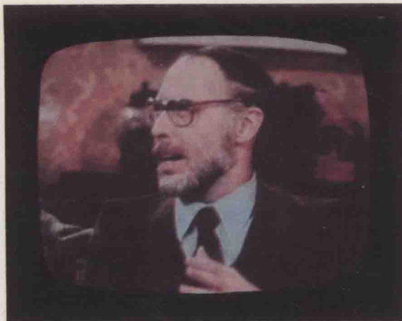
彩色板 2. 很紅的面 示過量彩色，飽和（彩色） 控制器順時針方向旋轉太遠
