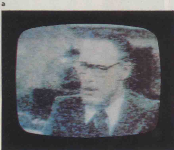
彩色板23 AGC延滯控制器之效應 (a)不足之AGC延滯，導致低調諧器增益及過量之雜波（雪花），(b)延滯被正確調節之圖景
