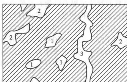
图1-4 耐火材料中的气孔类型
