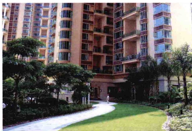
图 1.1-12 隐形的设计要使消防人员易于识别，否则车轮会陷入泥土中无法前行，可利用铺装，人为的设置标识。
