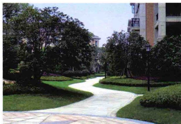
图 1.1-14 利用植物造景的手法以车道两侧多层次的列植或丛植乔灌木作为消防车道导向指示，景观效果好。
