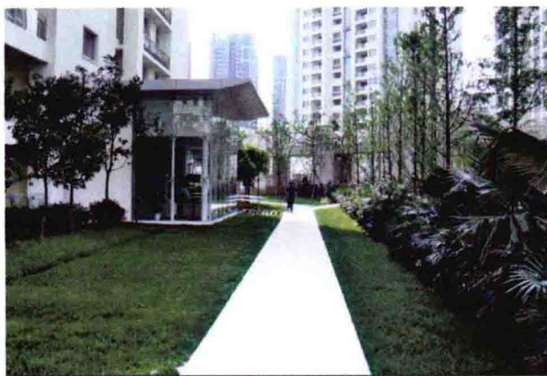
图 1.1-10 植草格作为隐形消防车道的设计，覆绿率可达 95% 以上，重量轻，易于安装，维护方便，车行人走都安全。
