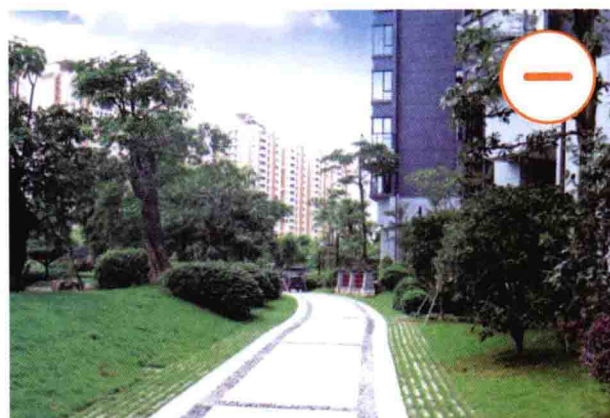
图 1.1-7 采用植草砖铺设隐形消防车道，即使没有碾压也无法长成自然草坪形态，效果难把控需慎用。
