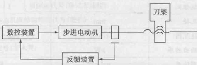
图 1-9 半闭环控制系统框图
