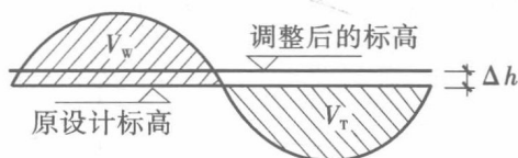
图 1.5 设计标高调整计算示意图
