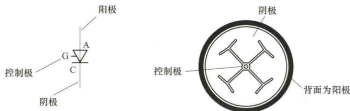
图 1-1 晶闸管器件示意图
