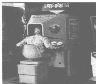
图 1.3 Link E. A. 发明的一种飞行模拟器 图 1.4 Morton Heilig 开发的摩托车仿真器 Sensorama
