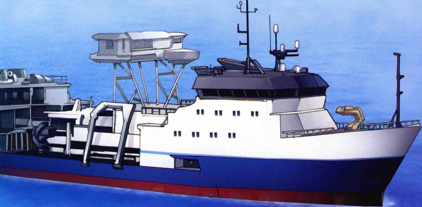
“北极星”号破冰船的船体能撞开6米厚的冰层，以每小时6千米的速度，连续开过1.8米厚的冰面，船体慢慢摆动，这样冰块就不会粘在船体上了。
