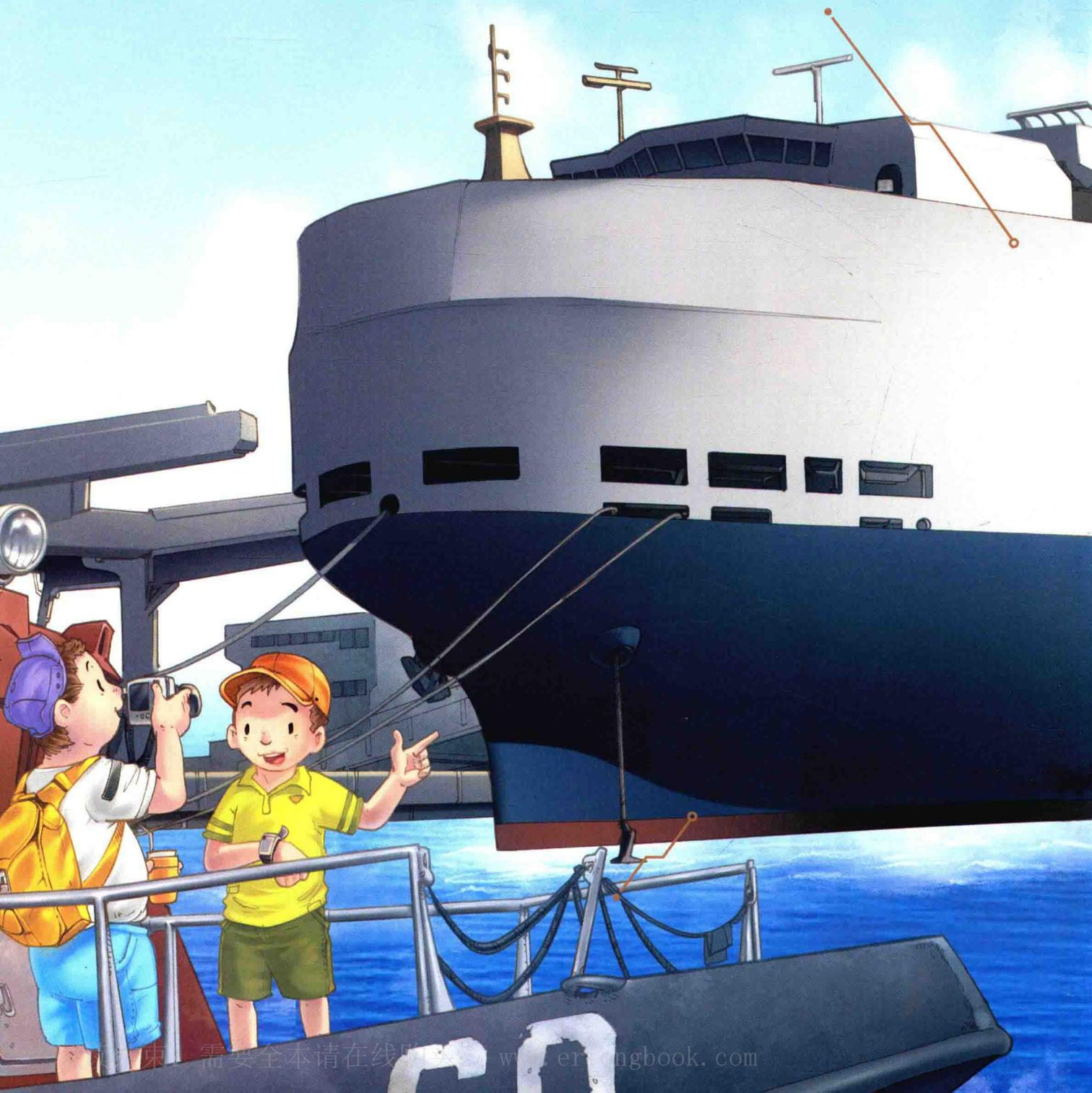
宽宽的船体中有好几层甲板，大货车可以顺着甲板开到船上，把货物哗啦啦地倒在滚装船的货舱里。甲板中间很少有立柱，这样货车、拖车就可以很轻松地拐弯了。
