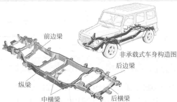
图 1-4 车架车身的框架结构
