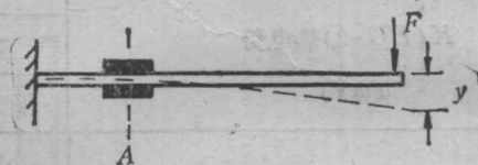
图 3-2 悬臂梁受力产生应变
