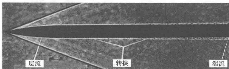
图 1.3 三维边界层从层流到湍流的过渡(阴影法显示) [5]
