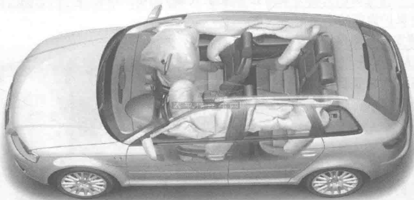
图 1-6 安装在车门内板中的侧面防撞用安全气囊
