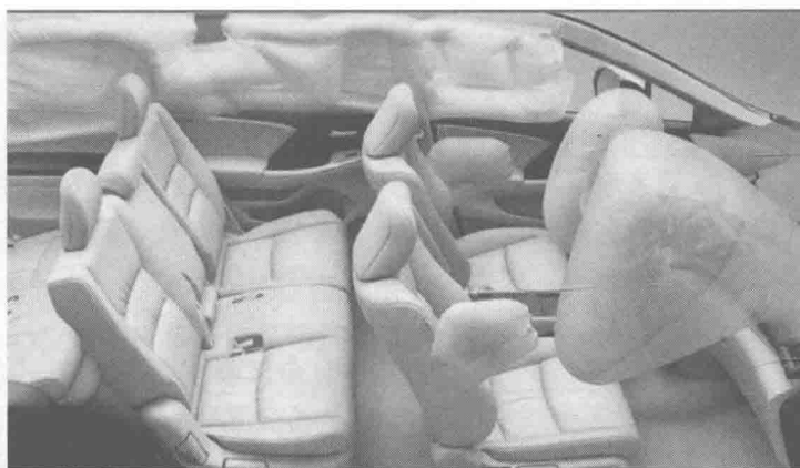
图 1-5 安装在车门上横梁中的安全气囊
