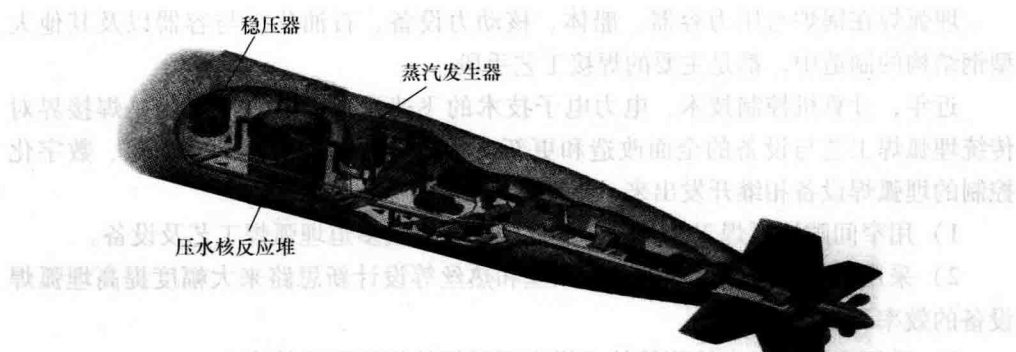
图 1-4 核潜艇的核动力主要结构 (船用压水反应堆、蒸汽发生器与稳压器)
