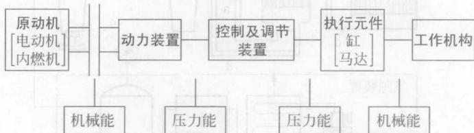
图 1.3 液压与气压传动系统能量转换和传递图
