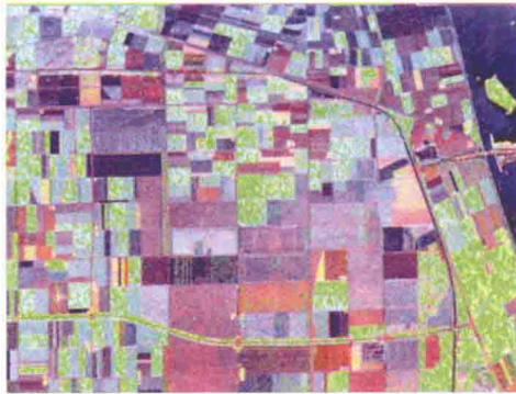
图 5.12 Freeman 分解, Flevoland, L 波段。 P_s (表面散射)为蓝色区域; P_v (体散射)为绿色区域; P_d (双反弹散射)为红色区域(POLSAR-PRO 分析结果)
