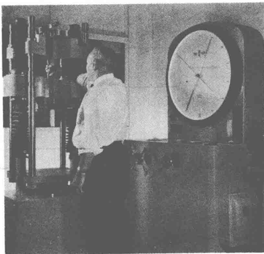
圖1-9 (a) 典型 60,000 磅 (600,000-N) 液壓操作張力試驗機。(b) 現在可以利用的三用閱讀標度。
