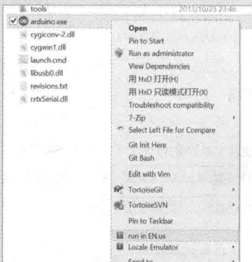
图16 使用Locale Emulator启动Arduino IDE，解决闪退问题
