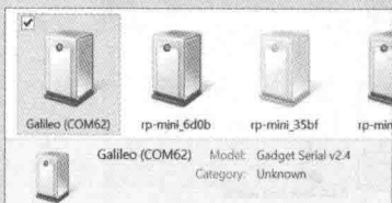
图13 被PC识别为串口的Galileo USB接口
