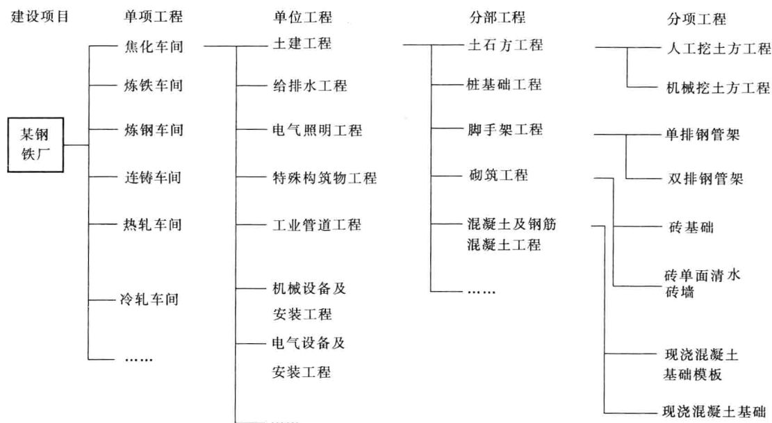
图 25-1 建设项目分解示意图
