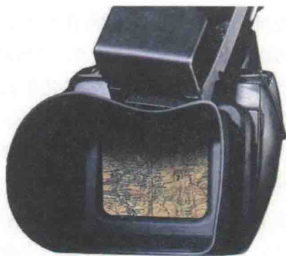
洛克卫尔·柯林斯（Rockwell Collins）公司开发的彩色头盔，安装显示器，可显示数字地图
