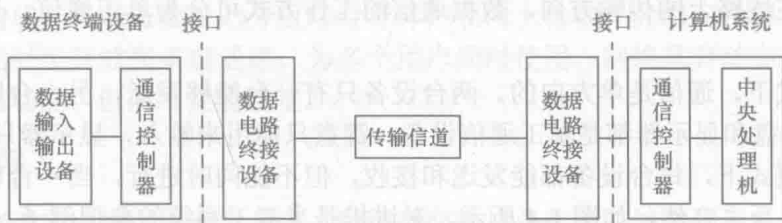
图 1-2 数据通信系统硬件组成
