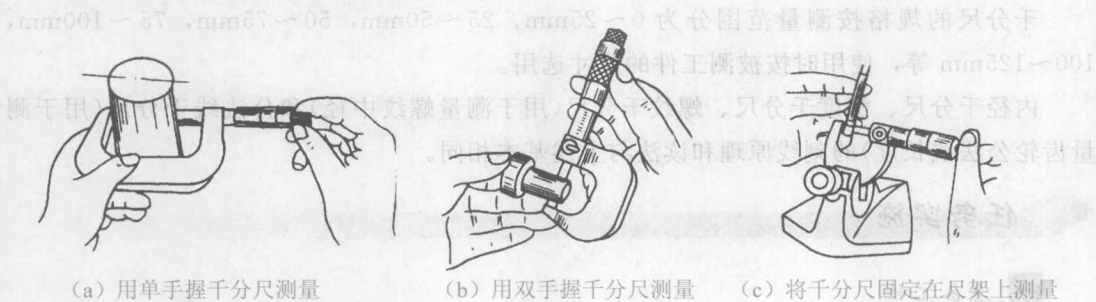
图 1-16 千分尺的使用方法
