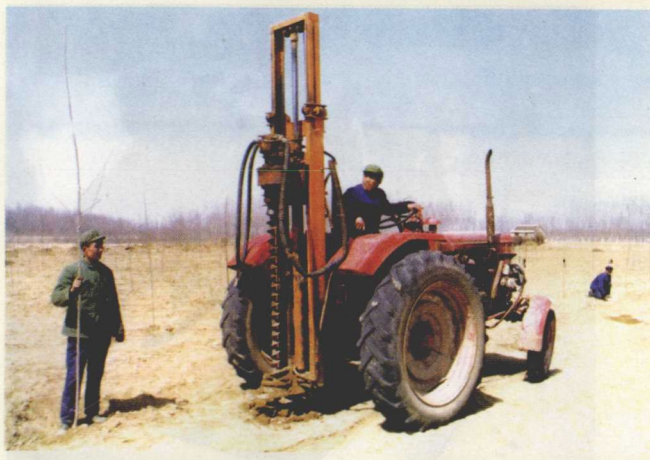
彩图 36 国产的杨树深栽钻孔机，每小时钻孔 50 ~ 60 个，孔径 12 厘米，孔深 2 ~ 3 米
