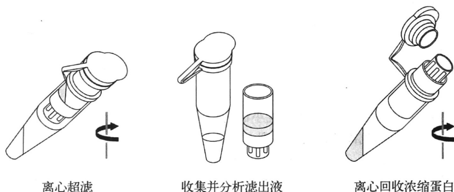
图 1-5 离心超滤示意图
