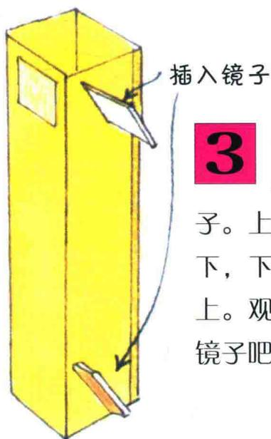
**3** 在上下插槽内分别插入两面镜子。上面的镜子镜面向下，下面的镜子镜面向上。观察一下下面那面镜子吧！
