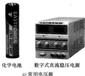
图 1-17 常用电压源及其电路模型
