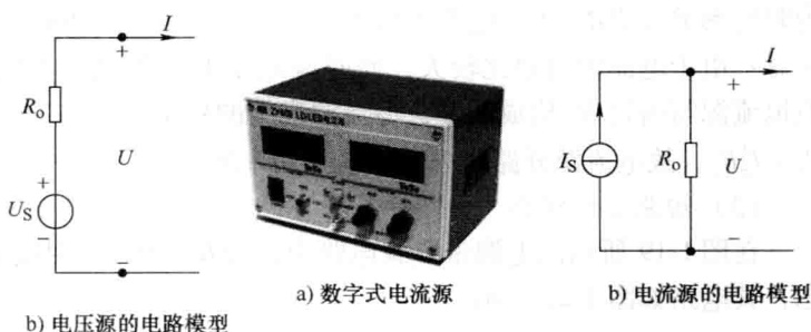
图 1-18 实验室中的电流源及其电路模型
