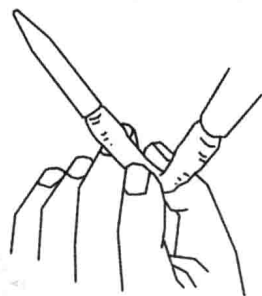
图 0.6 碱式滴定管排气泡
