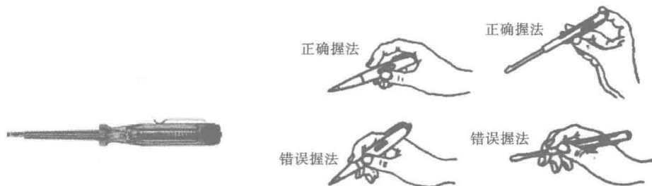
图 1-9 常用低压验电笔及其使用方法
