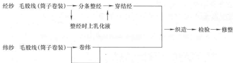
图 1-9 精梳毛织物的生产工艺流程
