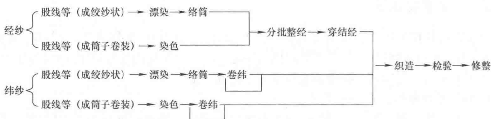
图 1-12 色织物股线、花式线的免浆工艺流程
