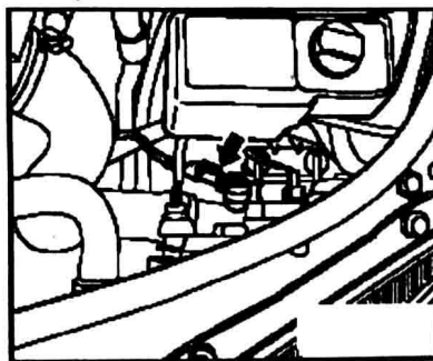
图 1-1-8 增压压力传感器 G31 安装位置图
