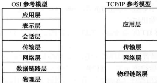
图 1-2 OSI 参考模型与 TCP/IP 参考模型的对照
