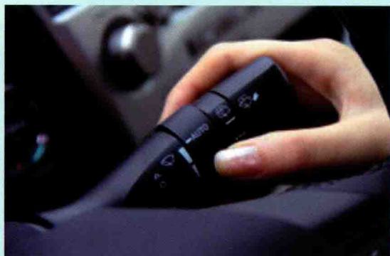
① 旋转内圈即可调节自动感应刮水器灵敏度
