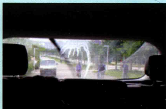
② 后刮水器启动后,刮水器喷水 and 刮水器工作
