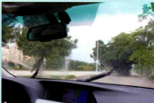
② 拨动刮水器后,启动前风窗玻璃刮水器喷水 and 刮水器工作
