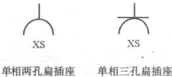
单相两孔扁插座 单相三孔扁插座 图 1-14 插座的图形文字符号
