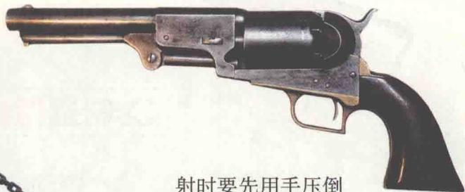
射时先用手压倒击锤，使它处于待击状态，然后扣动扳机射击。双动式既可用手压倒击锤使之待击，也可直接扣动扳机进行自动待击的射击。早期的转轮手枪多属单动式，而后期的多属双动式。
