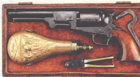
左轮手枪的独特之处在于，它的枪管和枪膛是分离的。左轮手枪通常是由这几部分组成的：枪底把、转轮及其回转、制动装置、闭锁、击发和发射机构。枪底把与一般枪上的机匣相类似，上面开有许多槽孔，以便将所有的机构和零件结合在一起，如枪管、框架、握把等。转轮、回转和制动装置通过回转轴固定在框架上，转轮既是弹膛又是弹仓，上面有6~7个弹巢，最常见的是6个，所以人们又把这种左轮手枪叫“六响子”。闭锁、击发、发射机构是左轮手枪最复杂的部分，按动作原理可分为单动式和双动式。单动式在发
