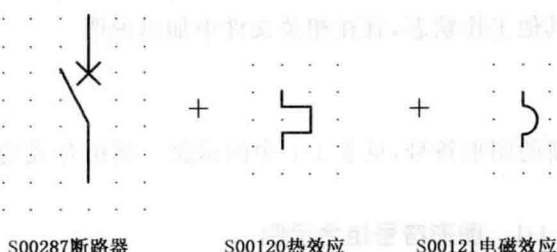
图 1-8 用热和电磁效应符号限定断路器符号示出的微型断路器
