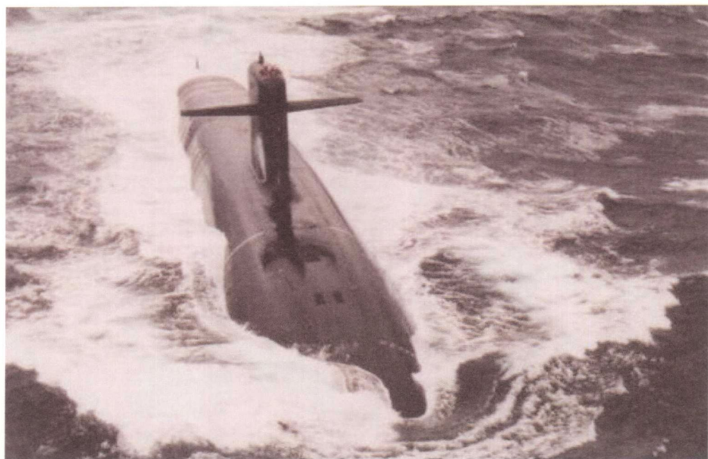
上图：法国弹道导弹核潜艇的发展和苏联一样，发展一型导弹配备一型潜艇。该级艇设置 16 具弹道导弹发射筒，设计装备 M-51 导弹，采用 TN-75 核弹头。该型导弹为三级固体燃料导弹，射程 11000 千米。
