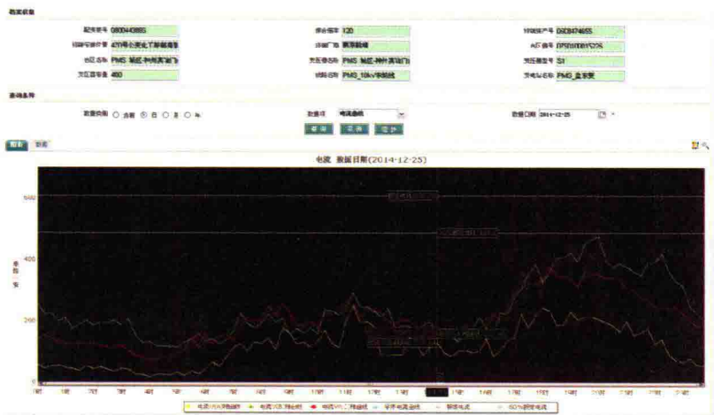
图 1-2-2 东城线 470 号配电变压器负载率
