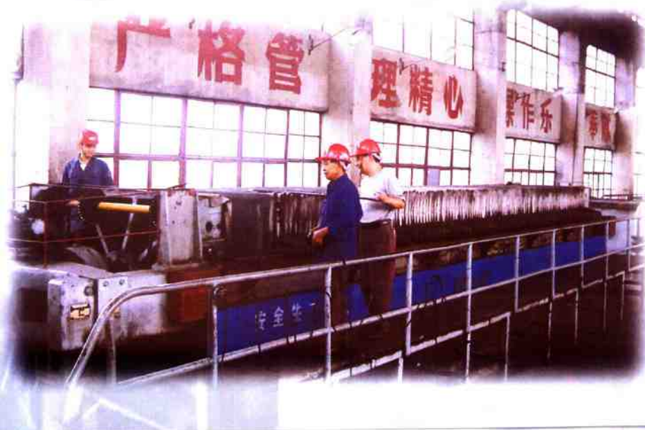
● 建造煤泥水压滤工程，确保了再生水 质量和洗煤生产用水
